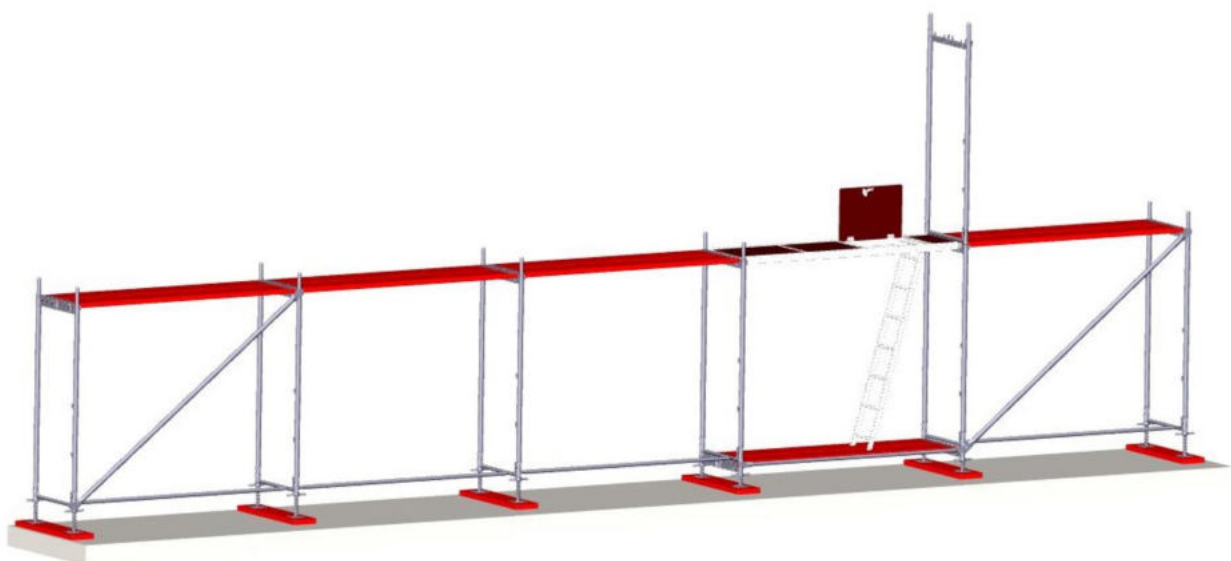
Rys. 7. Montaż pierwszej ramy następnej kondygnacji.
