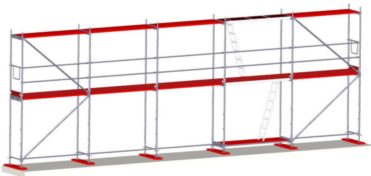
Rys. 10. Druga kondygnacja zmontowana wraz z poręczami i podestami.
